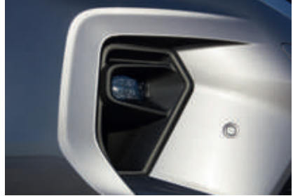
Dinamik Viraj Aydınlatma Sistemi ile LED Ön Sis Farı
